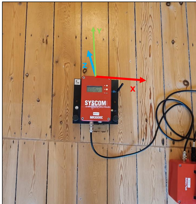
Appareil de mesure pour les vibrations DIN 4150-2
